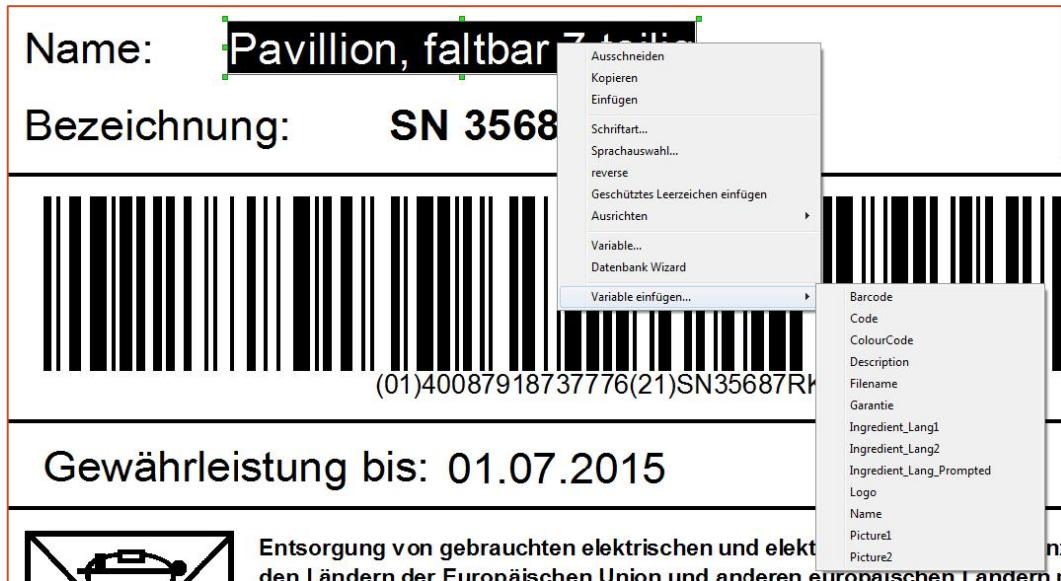
Auf die gleiche Weise ersetzen Sie die Bezeichnung mit der Datenbankvariable "Code" und das Garantiedatum durch die Datumsvariable "Garantie".
