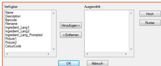
Einfach links alles markieren (Umschalt-Taste festhalten), **Hinzufügen** klicken, eventuell noch die Reihenfolge sortieren und mit OK übernehmen. Wenn Sie jetzt das Fenster mit den Variablen schließen und erneut öffnen, sehen Sie alle Variablen der Datenbank, die wir jetzt gleich auf dem Etikett platzieren.
